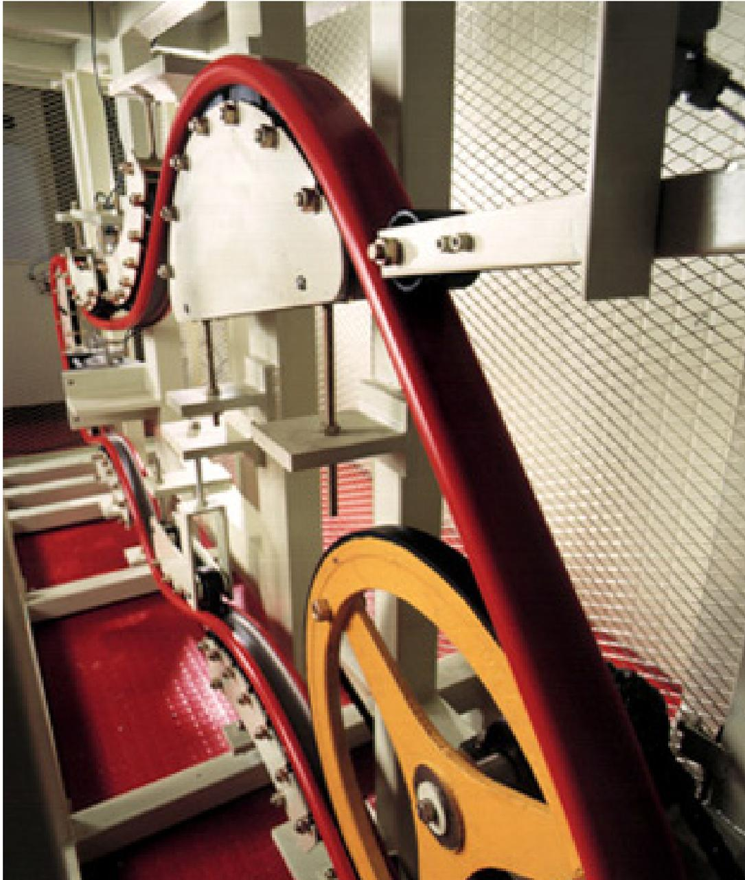
(그림 10. 핸드레일 주행 시험 장치)
